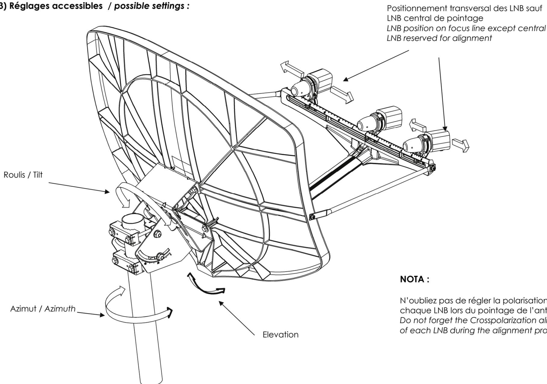
Installer le support LNB central en alignant le petit satellite du support sur la graduation 0.
